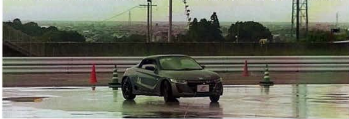
MR（ミッドシップエンジン・後輪駆動車）での走行 旋回中にアクセルを吹かし駆動力を与えると、 オーバーステアが発生し、リアが外へ滑り出します。
