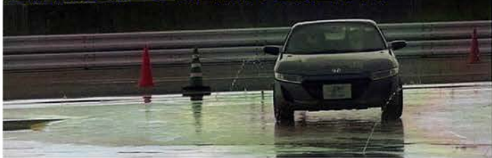
VSA（Vehicle Stability Assist） 車両姿勢制御補助装置での走行 ドライバーの操作と車の動きを感知して常に安全な 走行状態を保つように補助する装置です。
